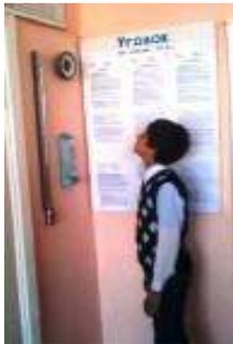
Атмосферное давление измеряют барометром-анероидом, основной частью которого является металлическая коробочка, из которой выкачан воздух. При изменении давления коробочка увеличивается в объеме или уменьшается. Пользуясь школьным барометром, я провел наблюдения за изменением атмосферного давления в феврале в течение недели. Увидел, что изменения атмосферного давления связаны с изменением погоды. [3]
